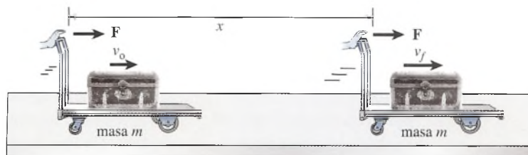
Figura 8.4 El trabajo realizado por la fuerza resultante F produce un cambio en la energía cinética de la masa total m . (Fotografías de Hemera.)
