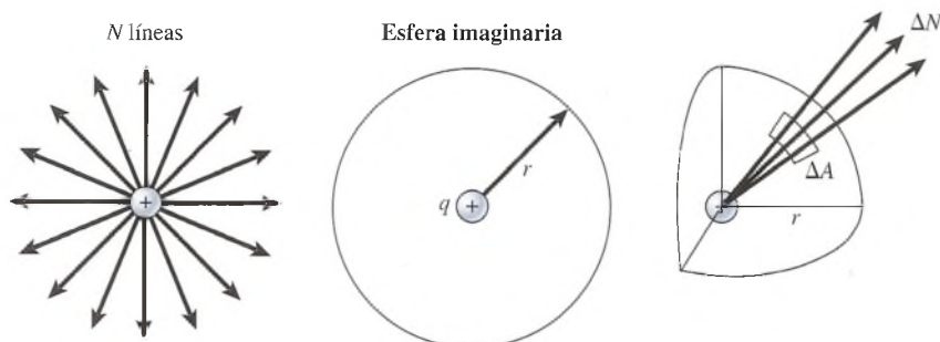
Figura 24.10 La intensidad del campo eléctrico a una distancia r de las cargas puntuales es directamente proporcional al número de líneas \Delta N que penetran por unidad \Delta A de una superficie esférica construida en esa distancia.
