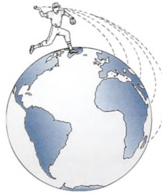
Figura 10.11 Una bola de beisbol lanzada horizontalmente con velocidad cada vez más grande tarde o temprano se convertiría en un satélite al “caer” alrededor de la Tierra.
