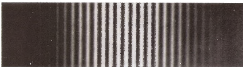
Figura 37.3 Fotografía de un patrón de difracción en el experimento de Young. (De F. A. Jenkins y H. E. White, Fundamentals of Optics , 4a. ed., McGraw-Hill Company, Nueva York, 1976. Reproducida con autorización.)
