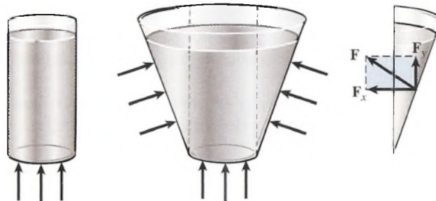
Figura 15.6 La presión en el fondo de cada recipiente sólo es función de la profundidad del líquido y es la misma en todas direcciones. Puesto que el área en el fondo es la misma en ambos recipientes, la fuerza total ejercida sobre el fondo de cada uno de ellos es también igual.
